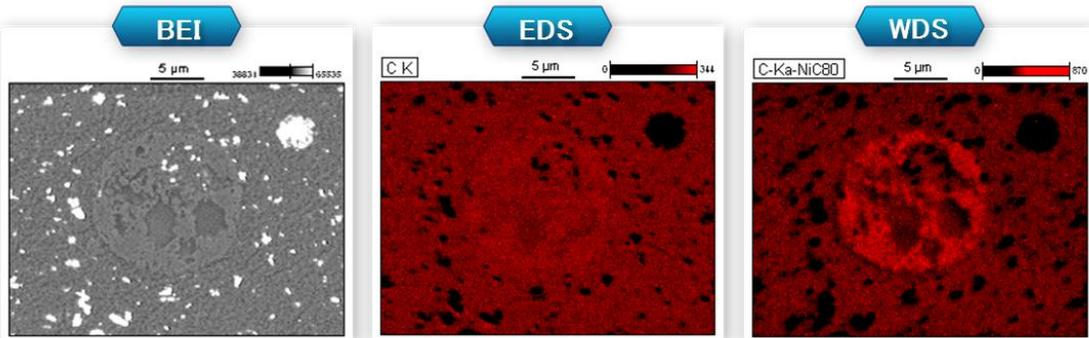
在取得的波谱仪(WDS)分析结果中,我们可以看到明显的碳的分布情况.在取得的能谱仪(EDS)分析结果中,却不那么明显.因为波谱仪检测极限和灵敏度更高,尤其是对轻元素的分析能力远远超出能谱仪.而波谱仪对探针电流的要求也更高.
